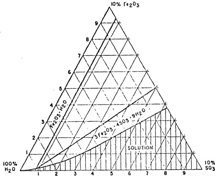
Fig. 25 System  $\text{Fe}_2\text{O}_3\text{-SO}_3\text{-H}_2\text{O}$ . Equilibrium at  $110^\circ\text{C}$  104
