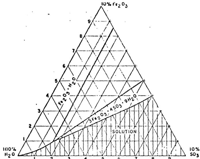
Fig. 24 System  $\text{Fe}_2\text{O}_3\text{-SO}_3\text{-H}_2\text{O}$ . Equilibrium at  $75^\circ\text{C}$  104
