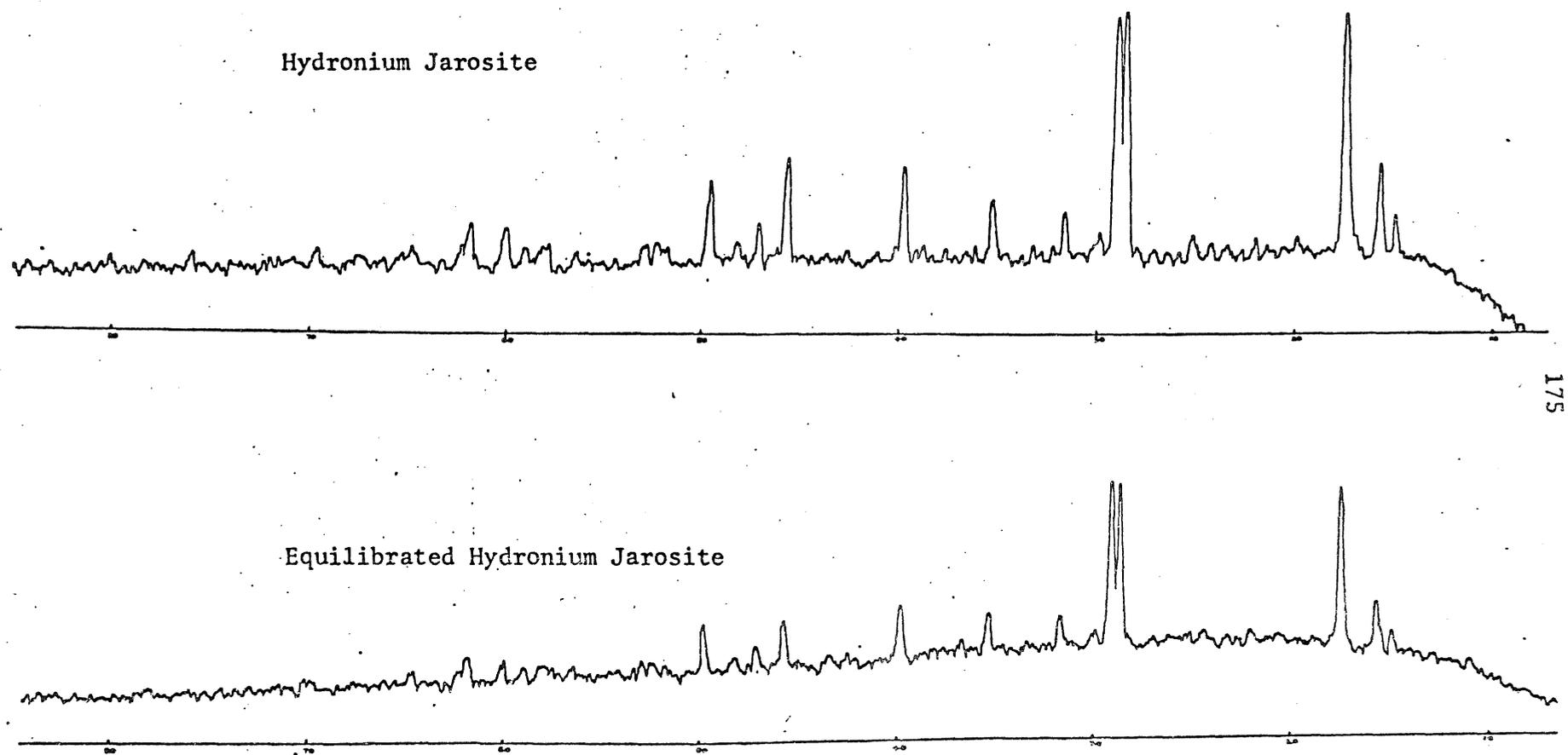
FIG. 59. X-RAY DIFFRACTOGRAPHS OF HYDRONIUM JAROSITE BEFORE AND AFTER EQUILIBRATION
